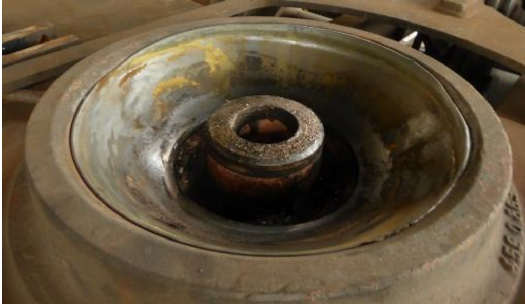
Figuur 14: onregelmatige slijtage in de kom van het draaistel [bron: foto Dekra]
