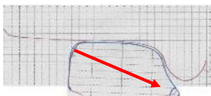
Figuur 22: combinatie wielband – spoorstaafkop
