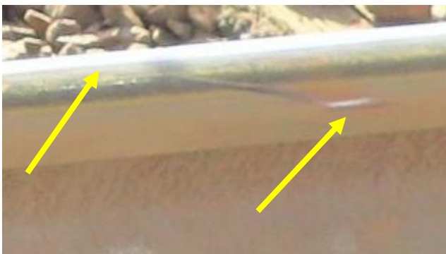
Figuur 9: bij dwarsligger 37 rolt een rechter wielflens over de rechter spoorstaaf. [bron:Politie]
