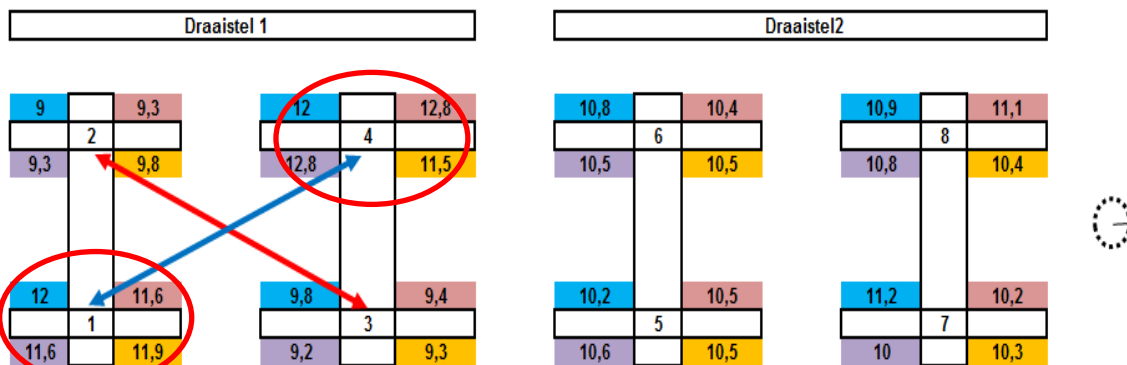
Figuur 18: per wiel de uitgeoefende verticale kracht op de spoorstaaf bij passeren van vier QV meetstations
