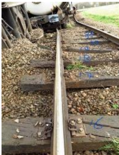
Figuur 20: dwarsligger 17 heeft als eerste vanaf dwarsligger 44 een correcte bevestiging van de spoorstaaf
