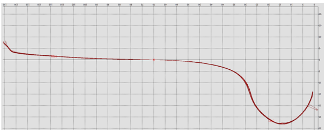
Figuur 13: gemeten 2 x 8 profielen van de wielbanden op elkaar gelegd [bron: meting Dekra]
