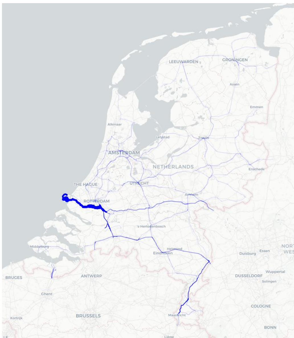
Figuur 5 Goederenvervoer - Visualisatie van het transportvolume. Hierbij correspondeert de dikte van de lijn met de hoeveelheid ton die over een bepaalde spoortak is gereden in het jaar 2022 door dieselmaterieel.
