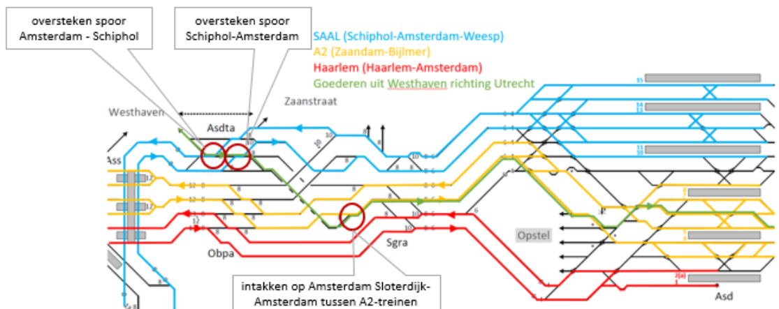
Figuur 2: Oversteken Westhavenpad via middenviaduct op Transformatorweg Aansluiting 2019 (stand 8-12-2017)
